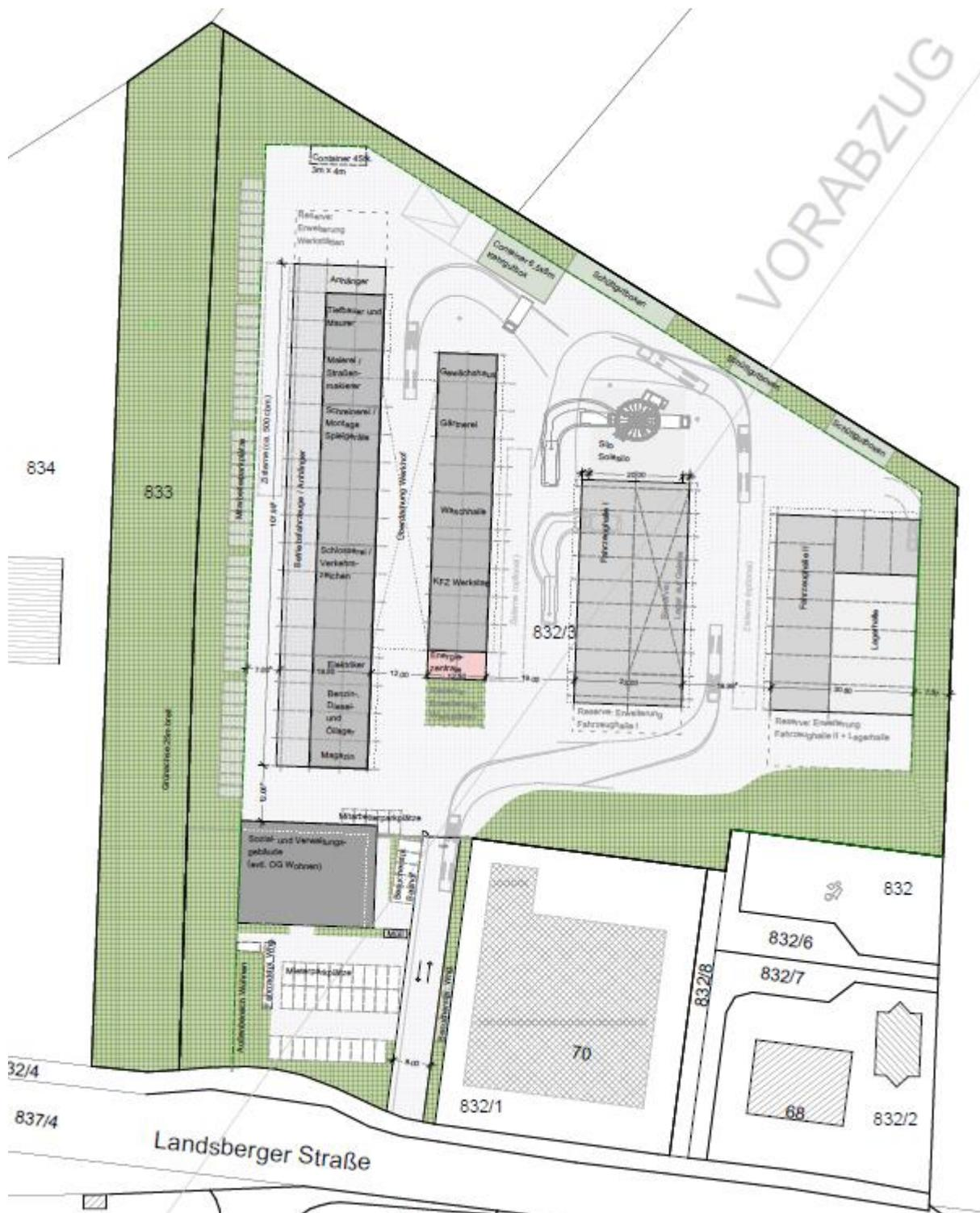
Abb. 4: Lageplan mit Anordnung benötigter Gebäude- und Verkehrsflächen
